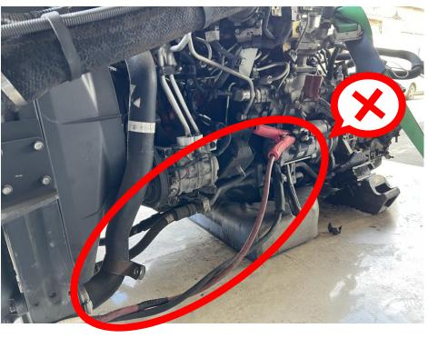
エンジンのセルモーターに直接電源をつないで動作確認をすると
