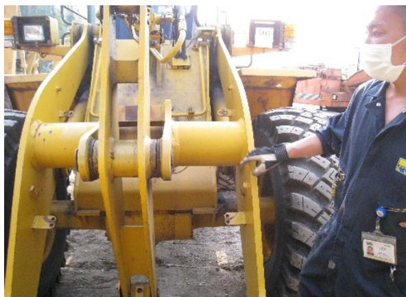
作業機における作業での一番負担となる部分に対し、機械のチェックでは最も重要な部分である。曲り、亀裂、破断等、重要なチェックとなる。
