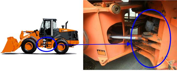
負担のかかる作業等に使用された機械では、フロントフレームとリアフレームとの連結部分、特にリアフレーム側に連結の支点部分に損傷、曲り、フレームの亀裂、その修理跡が残っている場合があるので、注意が必要であると共に、チェック時におけるポイントでもある。
