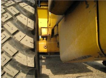
右写真を参照し、リアアクスルを突き上げ、リアフレームに損傷がある場合もあるので注意が必要である。
