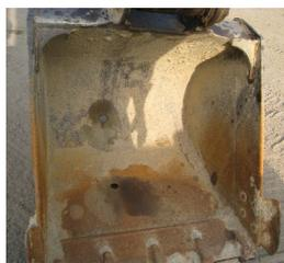
機械に装備されている作業機アタッチメント(バケット等)、表、裏面、付属のツメの磨耗、損傷等もチェックを行うことも忘れずに。
