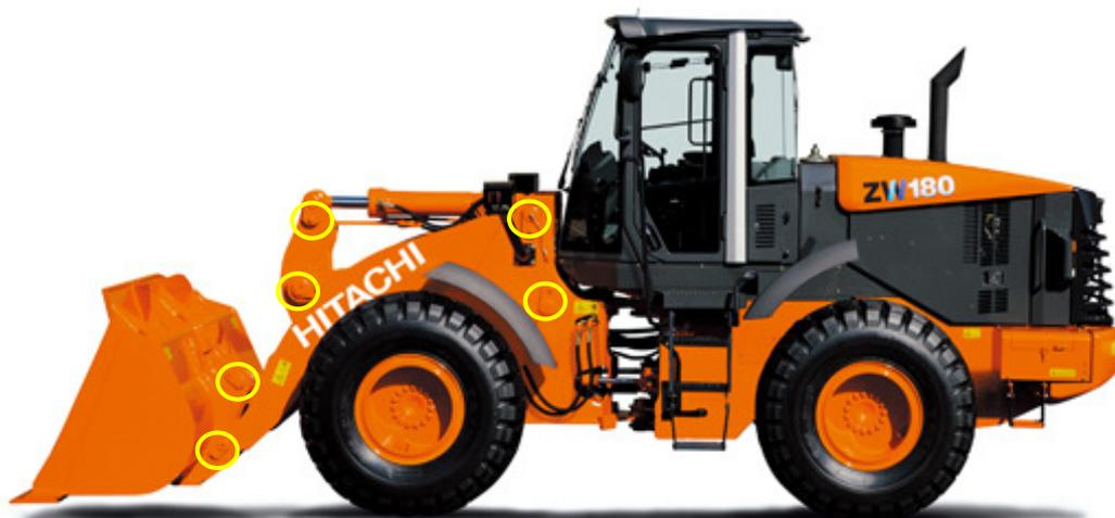
リフトアーム⇒ タイヤショベル・ホイールローダー前部に取り付けられているH形をしたパーツで、油圧シリンダー(アームシリンダー)の力で上下動し、バケットシリンダーやリンクなどとともにバケットの可動部分を構成してバケットを上下させる役目をします。
