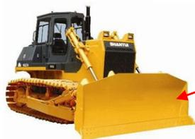
トラクターに排土板(ブレード)と呼ばれる作業装置を取り付けて、掘削、整地押土などの作業に用いられる。
