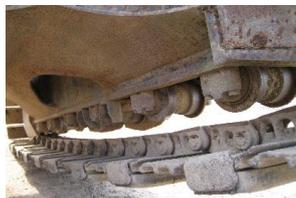
作業機にて車体を持ち上げた状態の時、左写真中、赤枠で囲んだ部分(トラックローラーとシューとの隙間を確認)
