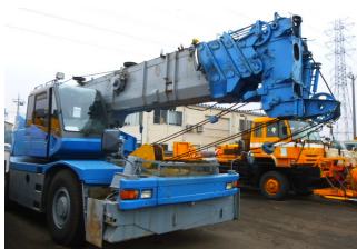
ラフタークレーン
