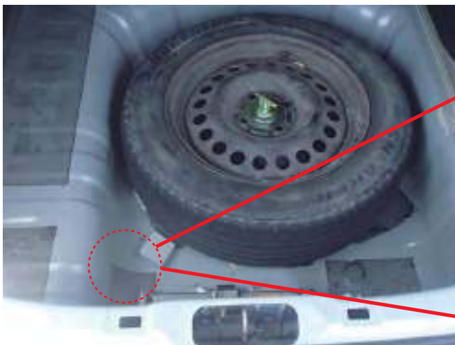
エンドパネルとトランクフロア接合部のシーラント
