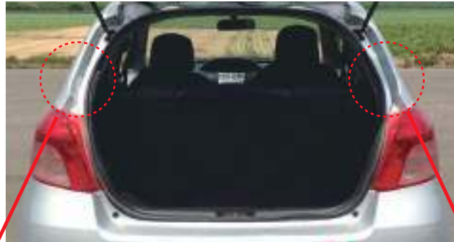
リヤフェンダー接合部のシーラント
