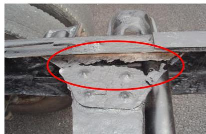
腐食によるガセットの亀裂
