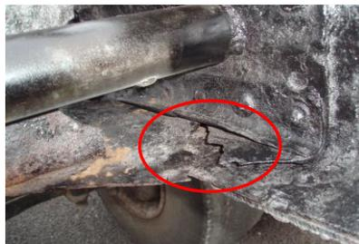
腐食によるガセットの亀裂
