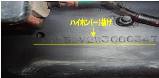
左写真【写真9】のように、車体ナンバーを偽造等行った車両等もあるので、確認のさいに打刻の確認だけでなく、その周辺様子(状態)も入念にチェックを行う必要がある。
