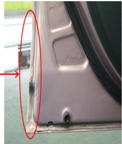
(後入れシーラー) 交換
